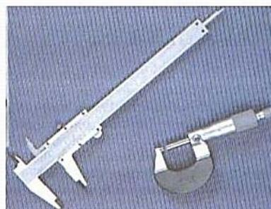
**Paquímetro e micrômetro.**
